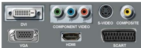
Slika 22. Deo tipične video konekcije HDTV prijmnika (uvećano)
